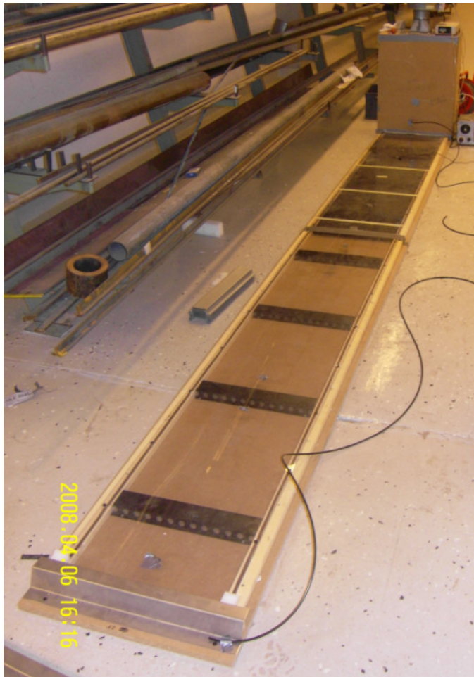
Fig 6 Bild som illustrerar hela spalten med plåtläkt och tryckutjämningsboxen i nederkant. (datum stämmer ej)
