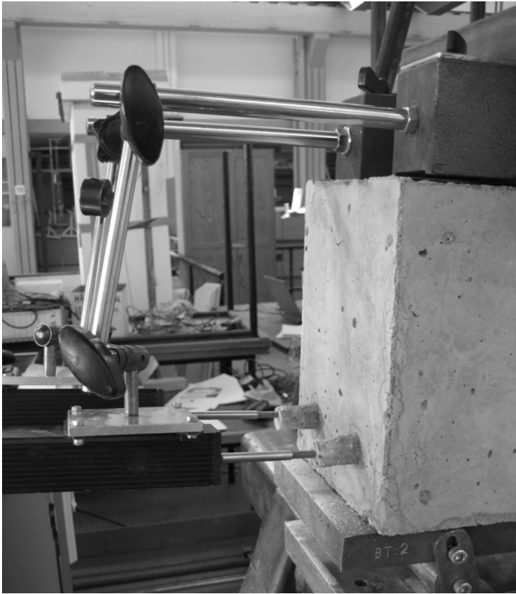
Fig 5.2 Foto från balkförsök som visar glidningsgivarnas placering.
