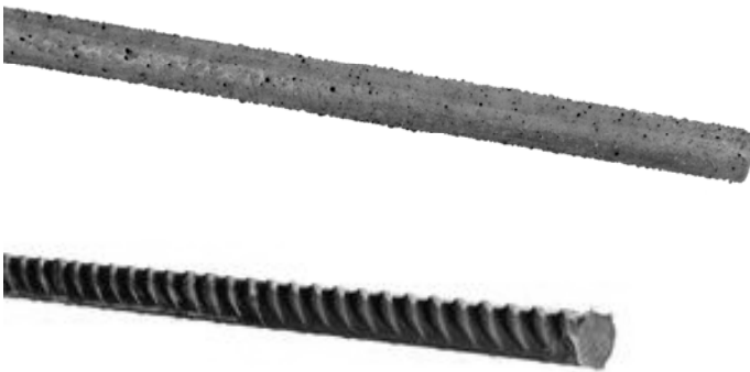
Fig 2.2 Glasfiberarmering överst, kamstång i stål nederst [9].
