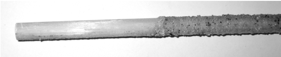
Fig 4.7 Bild på avskalad glasfiberstång. Ytskiktet upplevdes som kladdigt inför testet.
