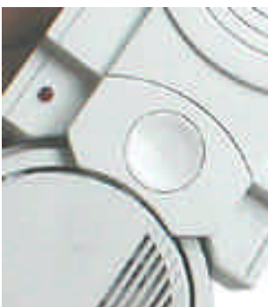
Bild 5.11 Lysdiod för optisk larmsignal och testknapp utformad för att passa intryckning till exempel med hjälp av ett kvastskäft.
