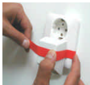
Bild 5.12 En klisterremsa gör att kontakten till Certec-Brandtalaren ej dras ur av misstag.
