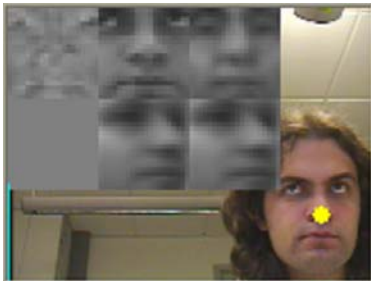
Figur 44. I den övre raden ansiktsbilder visas Y - Y_f , Y + M och Y_f + M . Den undre raden visar en egenansiktsbas byggd på semiprofilbilder, som för tillfället inte användes i programmet. Pricken visar centrum för den rektangel i bilden som använts för att generera Y .
