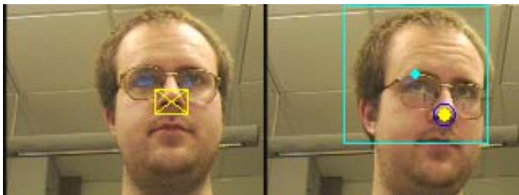
Figur 20. I bilden till vänster har assistenten just markerat näsan som det område algoritmen skall följa. I bilden till höger har den hittat något som liknar innehållet i kryssrutan. Det som algoritmen hittat, i det här fallet näsan, markeras med en prick.
