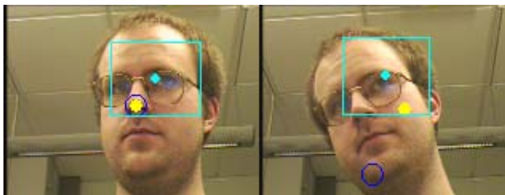
Figur 21. Algoritmen har till höger misslyckats med att hitta något som liknar en näsa tillräckligt mycket. Problemet är att Arvid har roterat huvudet, och alltså även näsan, så att den inte längre liknar det ursprungliga området.
