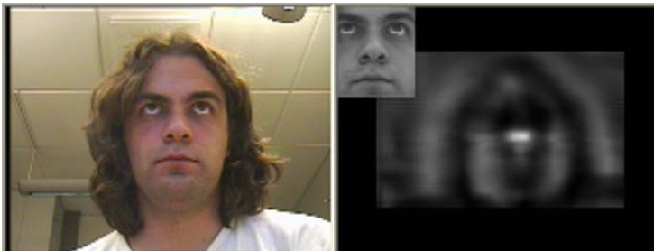
Figur 46. För att generera bilden till höger har vi låtit en rektangel av konstant storlek svepa över bilden och för varje läge beräknat det kombinerade avståndet från rektangelns innehåll till medelansiktet. Den infällda ansiktsbilden visar vilken position som gav den ljusa fläcken i mitten. Ju ljusare punkt, desto mindre kombinerat avstånd.
