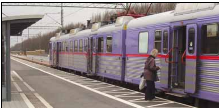
Figur 78 Nivåskillnad mellan plattform och pågatåg på Gunnesbo station
