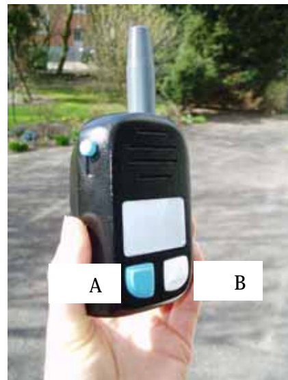
Bild 11.2 En radiodesign speciellt anpassad för målgruppen och användningsområdet Knapp A: 2-vägskommunikation Knapp B: Nödlarm
