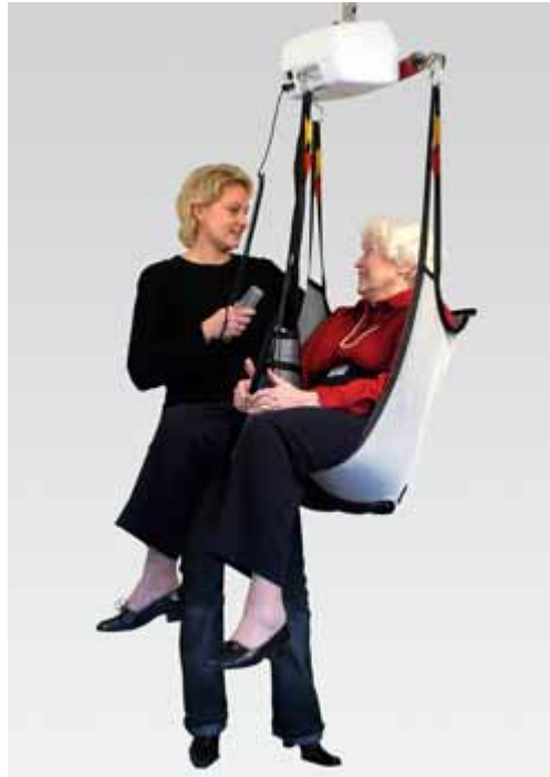
Figur 1.1. En taklyft från Human Care Lift. Den vita boxen är lyftmotorn. Vårdtagaren sitter i en lyftsele, som är upphängd på lyftmotorn och dennes teleskopgalge.
