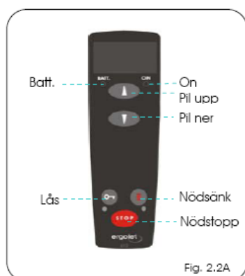
Figur 4.35. Lunas manöverkontroll, med nödfunktioner.
