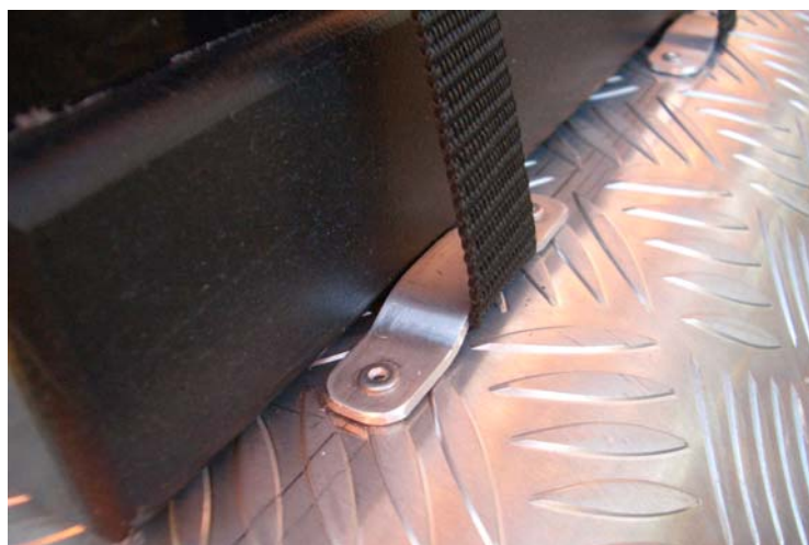
Bild 9-6, Remmarna som håller batterilådan på plats fungerar även som handtag vid lyftning
