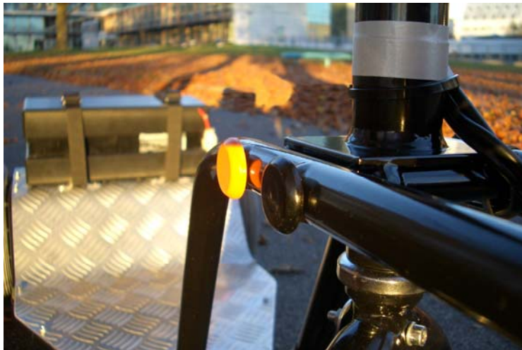
Bild 9-8, Färgkodad sprint som lossas för att fälla styrstången.
