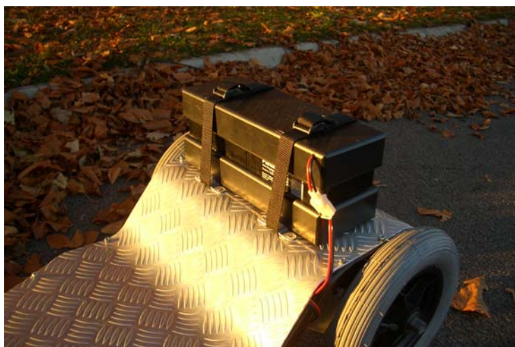
Bild 9-5 Cobra har en avtagbar batterilåda vilket underlättar lyftning.
