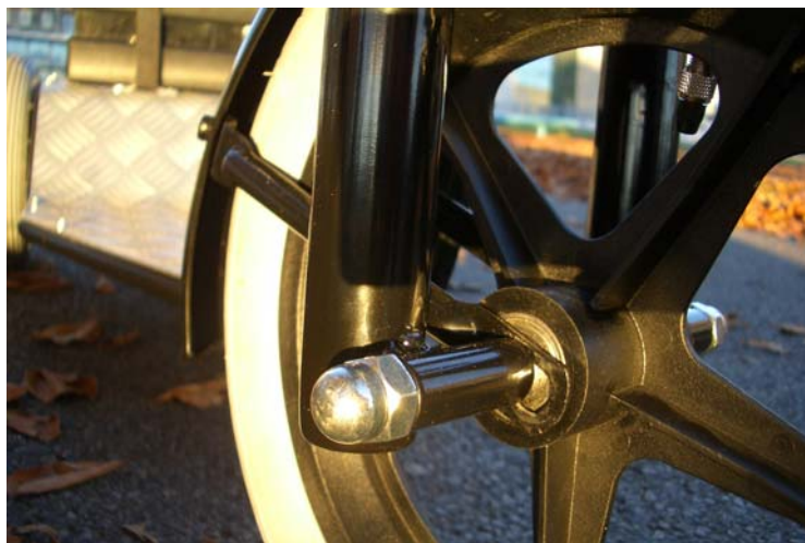
Bild 9-9, Lätta luftgummi hjul med ekrad nylonfälg
