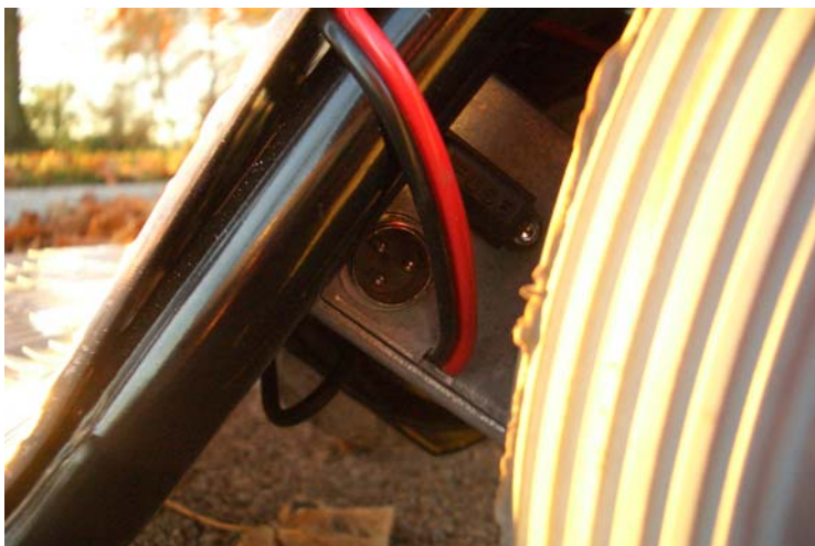
Bild 9-12, Säkring och kontakt för batteriladdning
