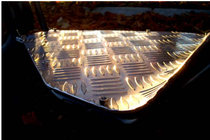
Bild 9-11, Ståplatta av aluminiumdurkplåt. Det vackra mönstret ger ett bra fotfäste
