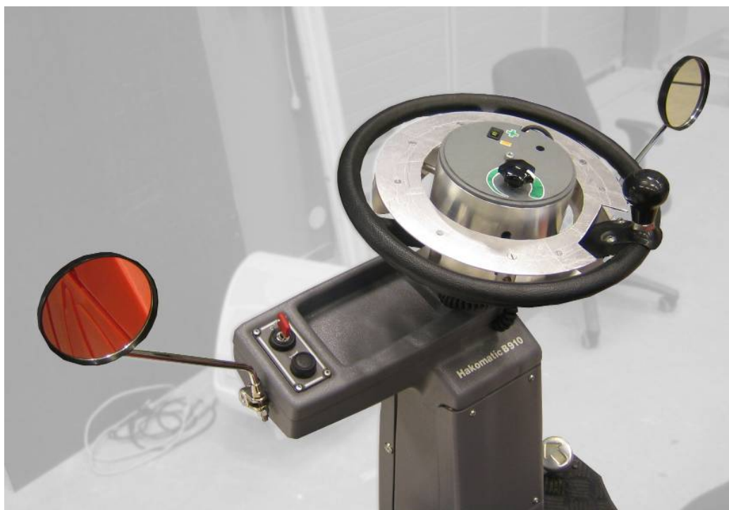
Anpassad ratt med handgas, hastighets- och back-reglage
