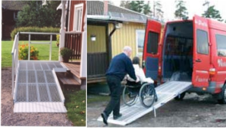
Figur 4.10 Systemramp och bakgavelramp 12
