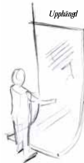
Bild 6.4 Rum utan rum. Mattan. Mattan kan vara i valfri storlek. Den är elektriskt föränderlig och styrs antingen genom laserstrålar eller trycksensorer som känner av när man rör vid mattan. Då sänds information till datorn som byter bild i mattdisplayen.
