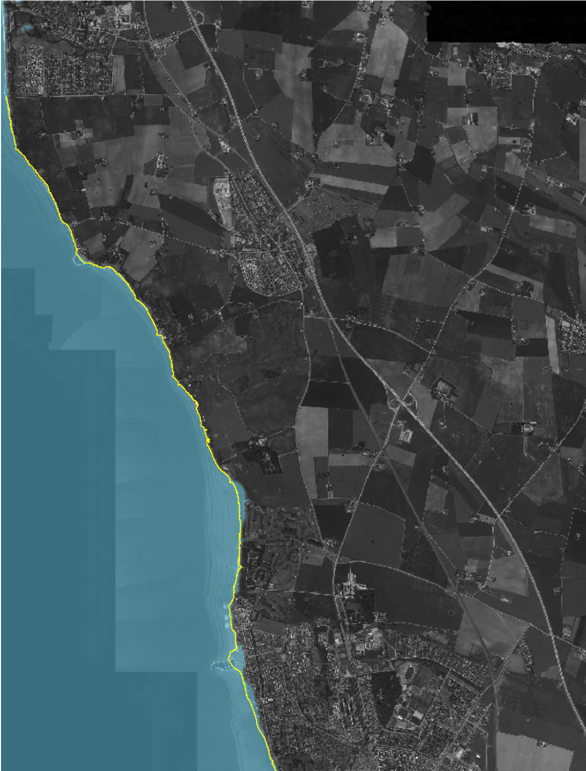
Figur 13-8 - Översvämningssimulering av framtida 10-års vattenstånd i de norra delarna av kommunen.
