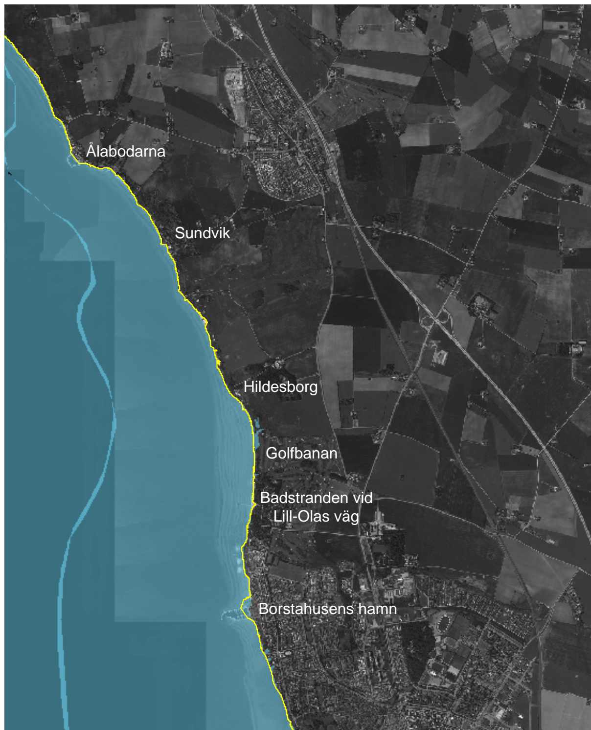
Figur 13-2 – Översvämningssimulering av nutida 100-års vattenstånd i de norra delarna av kommunen. Kustlinjens ungefärliga nuvarande läge är markerat med en linje.
