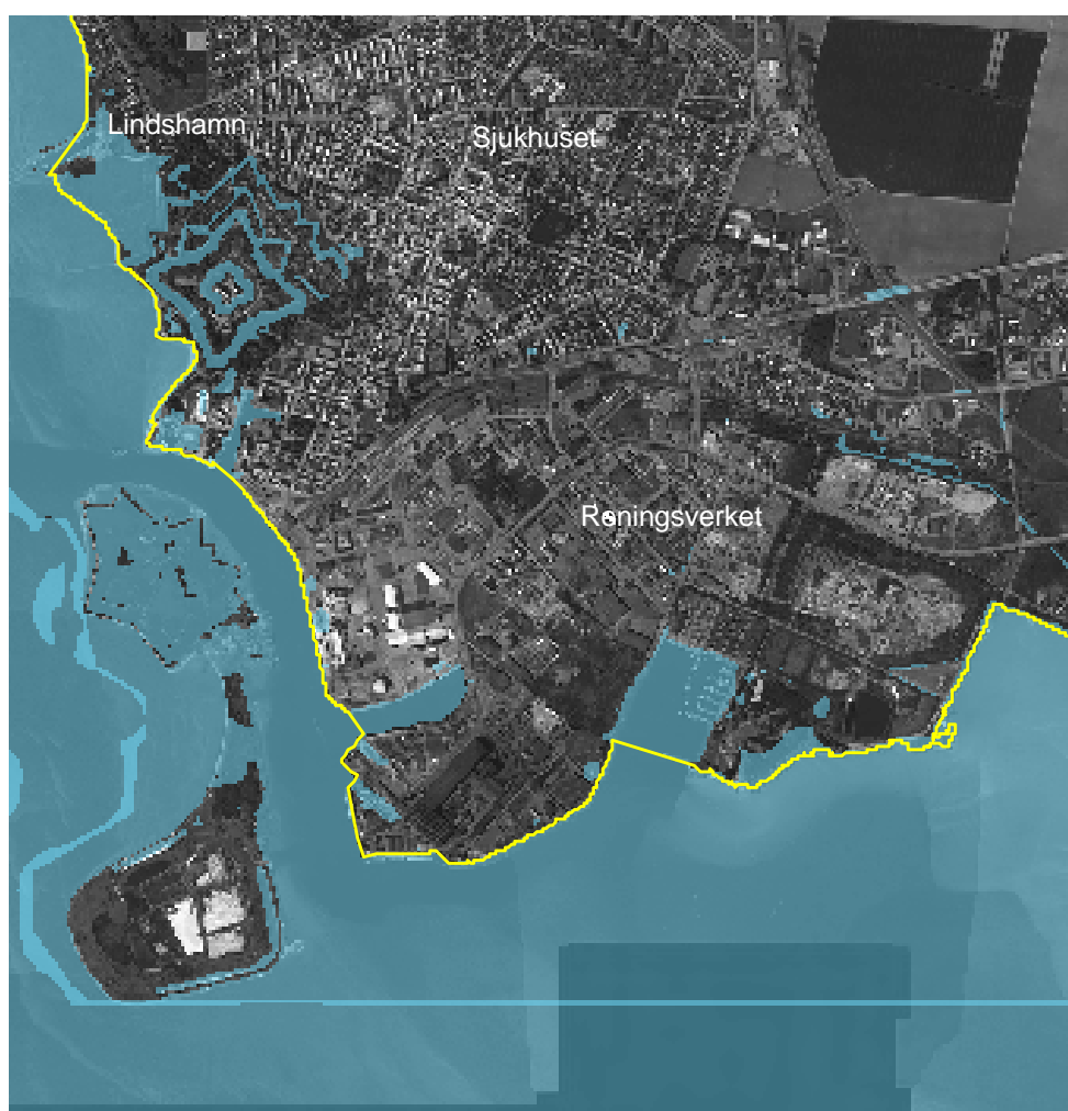
Figur 13-3 – Översvämningssimulering av nutida 100-års vattenstånd i de centrala delarna av kommunen. Kustlinjens ungefärliga nuvarande läge är markerat med en linje.
