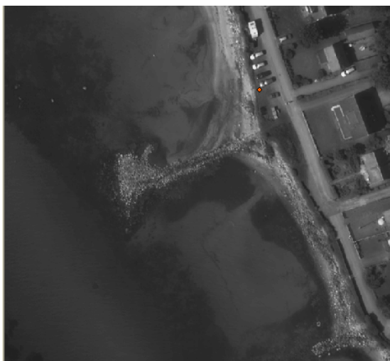
Figur 12-14 – Stenhövd söder om Sundvik där en viss ackumulation kan skönjas på den norra sidan av hövden.
