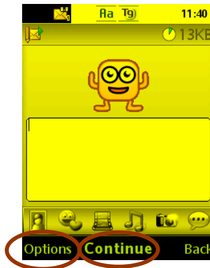
Figur 3.3 Softkeys De två inringade områdena är softkeys och motsvaras av två fysiska knappar på mobiltelefonen.
