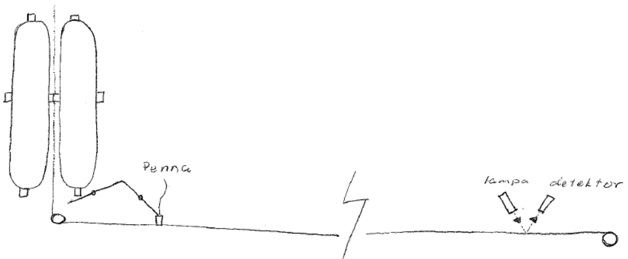
Figur 9 Principskiss för optisk markör
