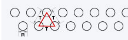
Figur 13. Perforerad plåt, hålplacering
