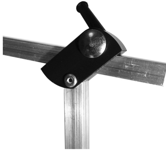
Figur 64. Låsningen av nackstödet i djupled
