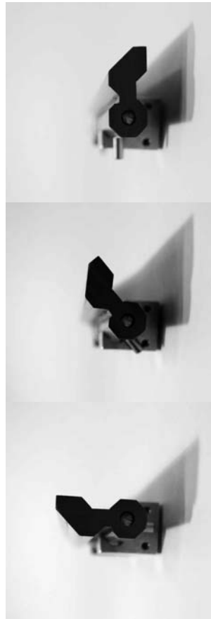
Figur 44. Svankmekanismens minsta, mellersta och största djup.
