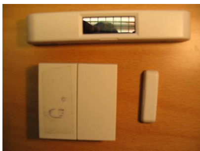
Figur 4.5: Högst upp ligger fönsterkontakten STM250 och nedanför till höger ligger dess magnet som fästs på fönster eller dörr. Nedan till vänster ligger tryckknappen PTM200.
