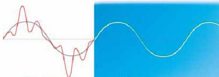
Figur 10, en bild som visar hur en signal med skadliga övertoner filtreras till en ren signal.
