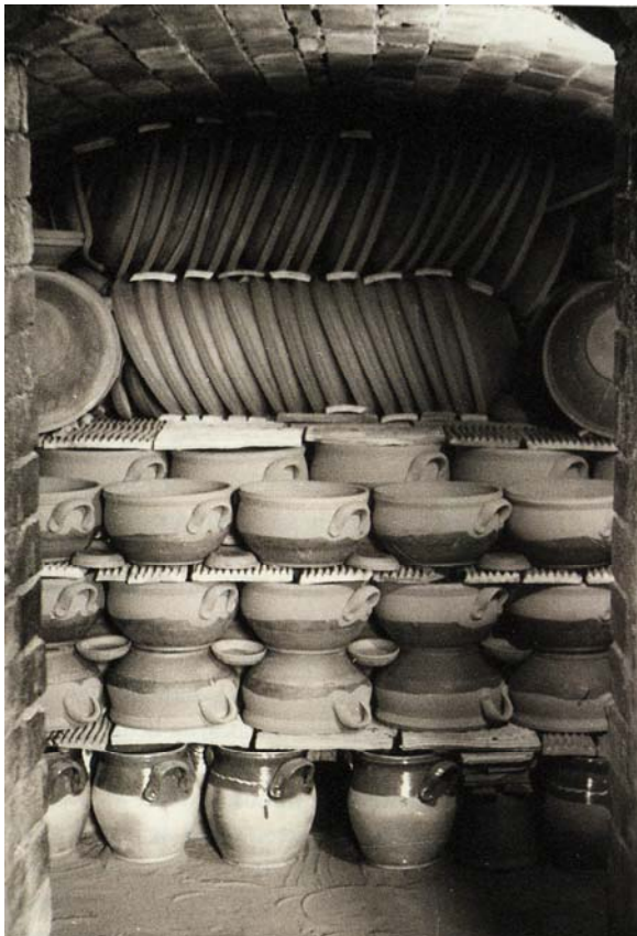
Figur 5. En närmast fylld brännugn från Martin Perssons krukmakeri i Kvidinge på 1940-talet.
