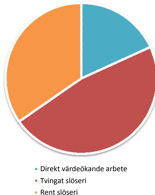
Figur 7 – Slöserier på byggarbetsplatsen (Josephson & Saukkoriipi, 2005)
