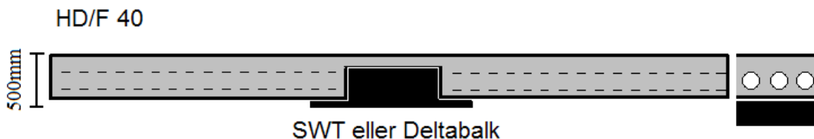
Figur 6.1 Sektion över bjälklagskonstruktionen i Sverige, Helsingborg.
