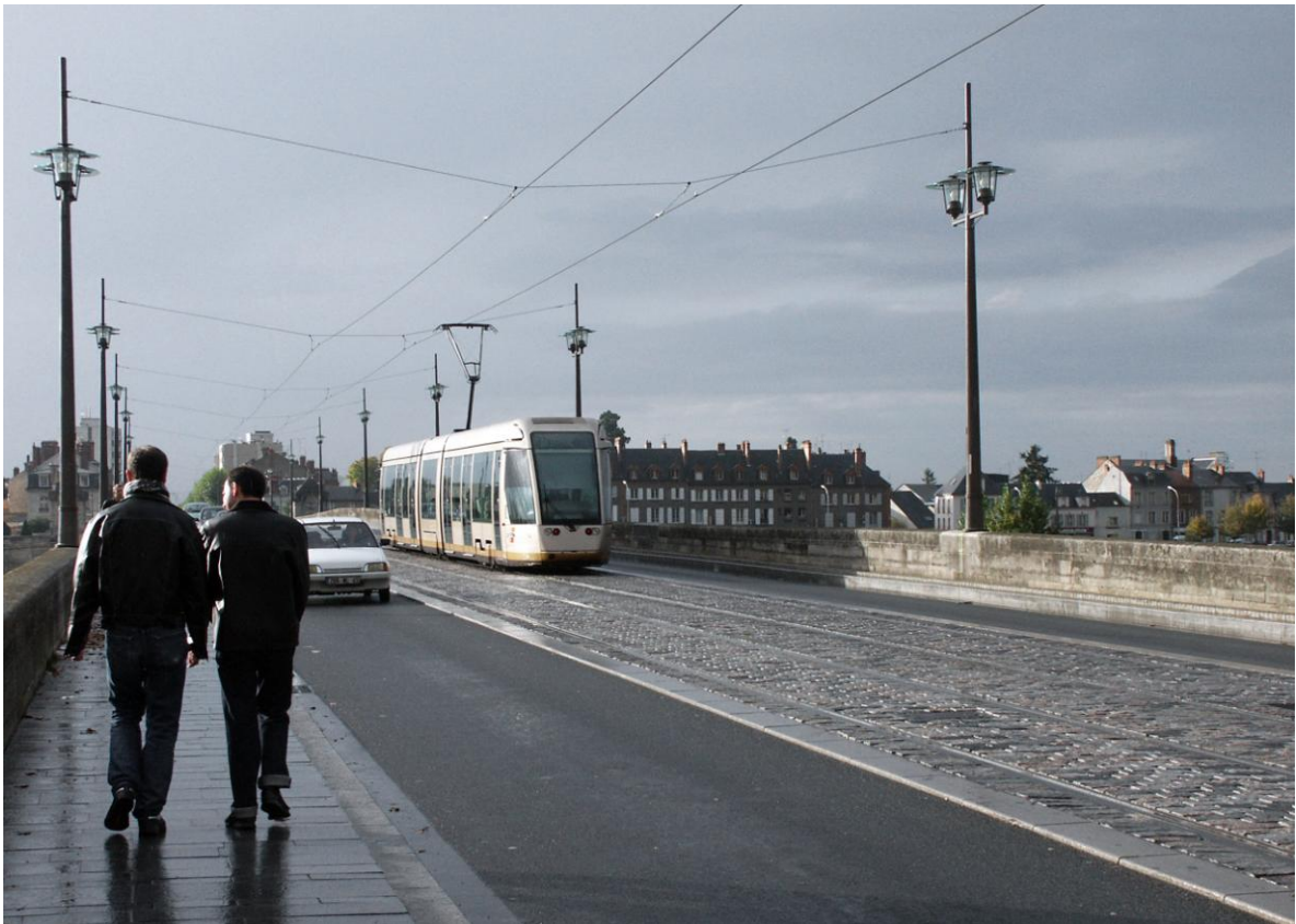
Figur 11 Spårvagn i Orléans med tillhörande kontaktledning i en triangelformad upphängningskonstruktion (Medgivande från Thomas Johansson ©).
