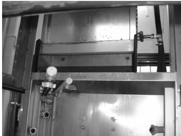
Figur 10.3 Bild inifrån diskmaskinen när huven är uppe. På anslutningslådan syns vertikala lister för tätning.
