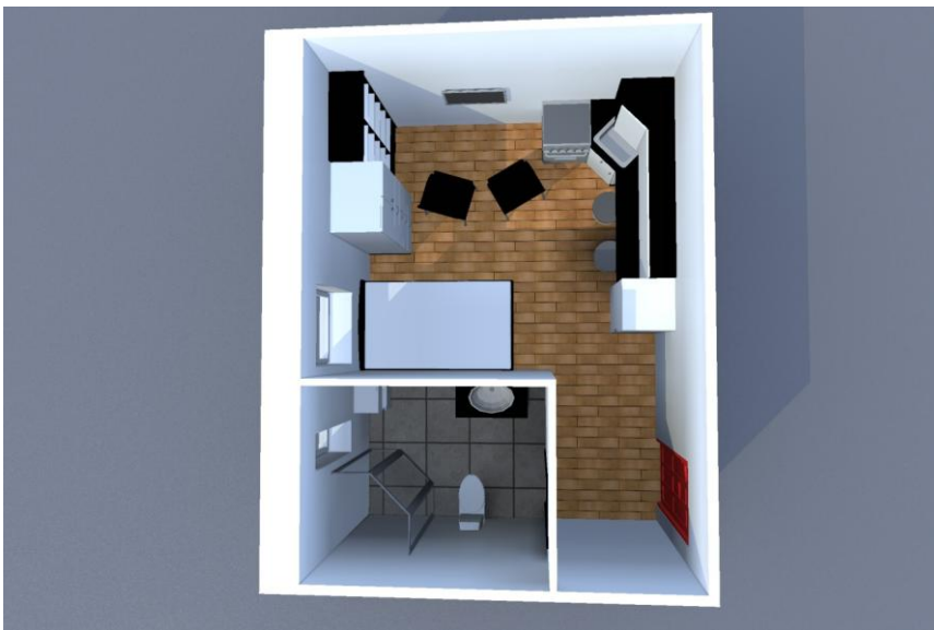
Detta är en bild tagen ur ett titthålsperspektiv och visar en av studentlägenheterna som är det väsentliga i denna byggnad. Man kommer in i hallen genom den röda dörren och har då badrummet rakt fram. Till höger kommer man genast in i lägenheten där man kan få plats med en 120cm säng, ett litet kök och även en liten yta för umgänge. Denna lägenhet är på 22 kvm.
