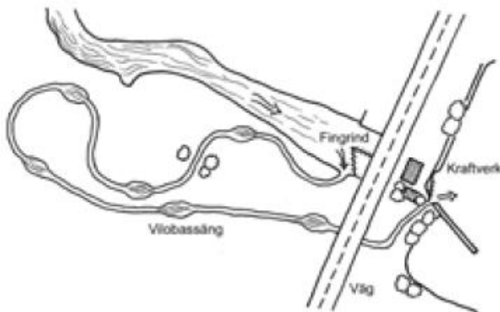
Figure 4. Fauna passage bypassing the Holstebro HPP, Denmark. (Source: Fiskeriverket och Naturvårdsverket, 2008)
