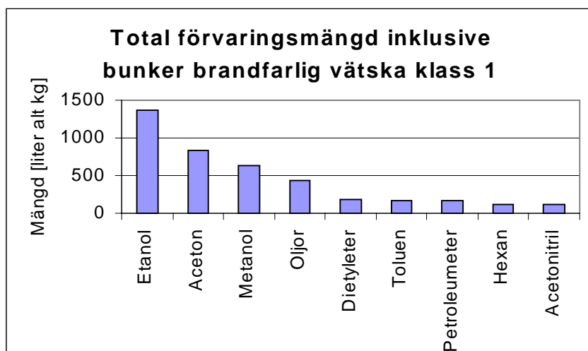
Figur 4.5 Ämnesvis sammanlagd mängd brandfarlig vätska klass 1, inventerad mängd. Totalt 1700 liter.
