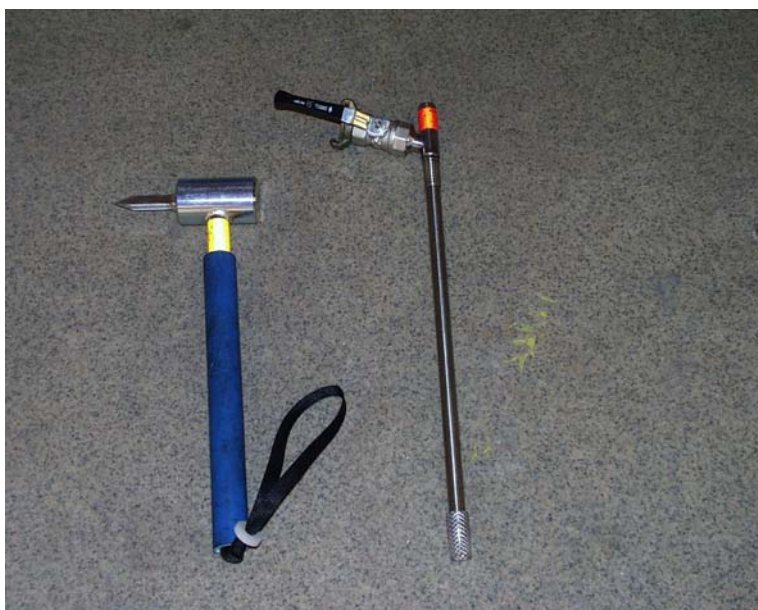
Bild M-3: Utrustningen: slaghammare och dimspik
