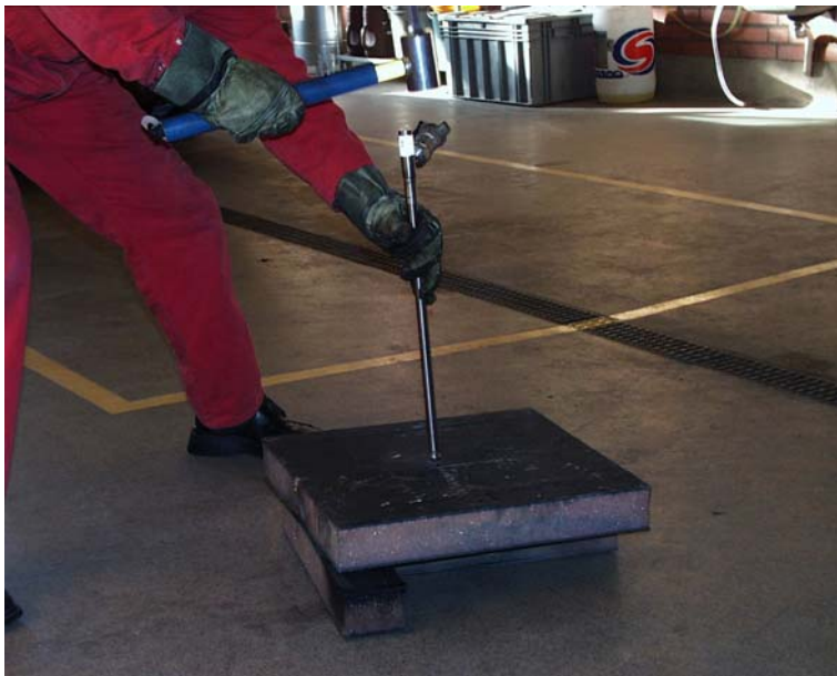
Bild M-5: Användningen av dimspik kräver plats som bilden visar
