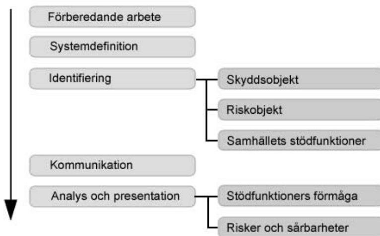
Figur 26 – Övergripande flödesschema för hur ramverket ser ut. Figuren visar de steg som ramverket består av. Arbetsföljden beskrivs av pilens riktning och varje steg är viktigt för att kunna utföra en komplett analys. Identifiering och analys och presentation består av olika delmoment som presenteras till höger om dessa punkter i flödesschemat.
