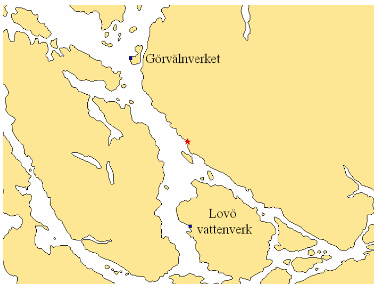
Figur 3.4.7. Stjärnan visar vald utsläppspunkt för simuleringar av avloppsutsläpp för bräddpunktens vid Berghamns brygga. Utsläppet har i simuleringarna antagits ske på 1 meters djup.
