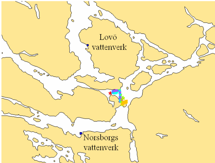
Figur 5.2a. Utsläppets simulerade utspridning 12 dygn efter utsläppets start vid Ekebyhovs reningsverk den 4/2-2003. I scenariot är Mälaren täckt av is. Stjärnan visar utsläppspunkten.
