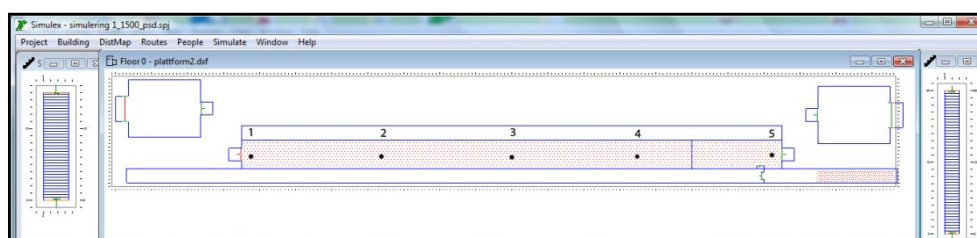
Figur 18: Uppställning i Simulex, utrymningssimulering brand 2.
