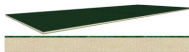
Figur 1. Illustration av en FRP-konstruktion med starka och fasta fiberarmerade laminat fästa på en lättviktig kärna.
