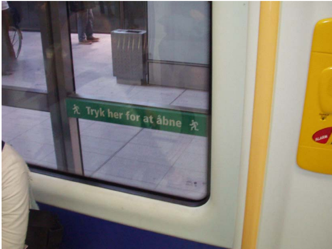
Fig. 12.1 Skyddsväggens nödöppningsfunktion syns genom vagnens fönster.
