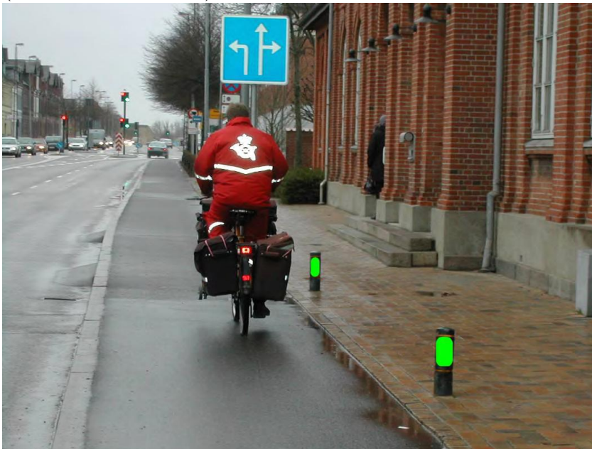
Figur 1. Gröna Vågen för cyklande med belysningsfundament för hastighetsanpassning. Källa: Vägverket (2008)
