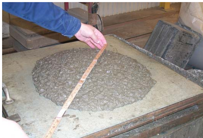
Figur 6.3 Utbredningsmått på fallbord.
