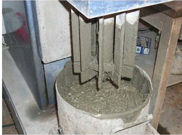
Figur 6.4 Yttre och inre cylinder på BML-viskosimeter WO-3.
