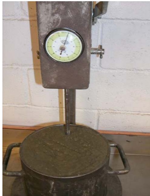
Figur 6.5 Inträngningsmotståndsmätare Dial Push-Pull Gauge Model DPPH 100 kg.
