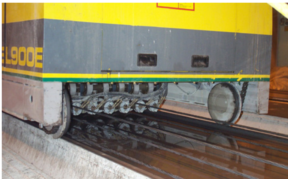
Figur 3 Munstycke som formar hålen i håldäcket.
