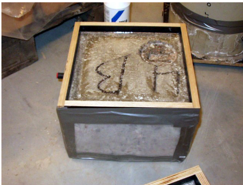
Figur 18 Provbit med uttagen ytfukt och träform för avjämningsmassa.
