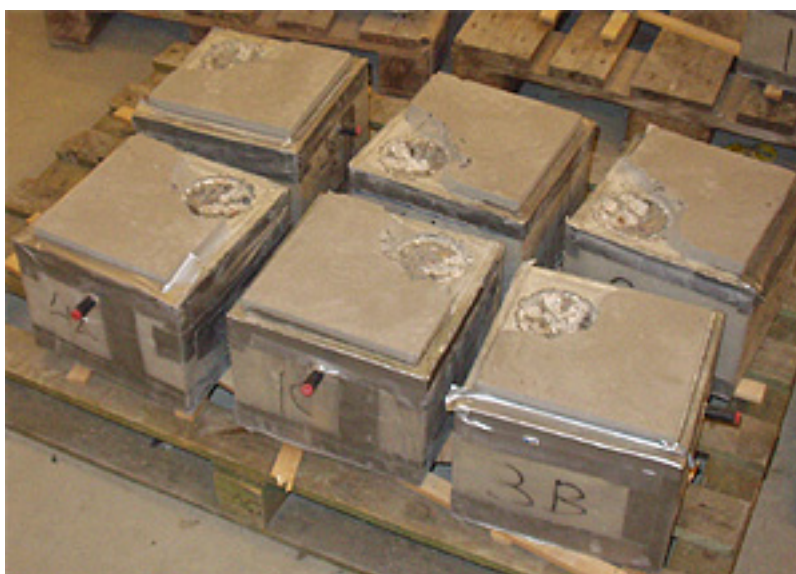
Figur 11 Bild på D/F provbitar efter slutytfukt i betong och avjämningsmassa tagits.
