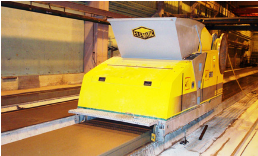
Figur 2 Figuren visar vagnen som rullar längs banan och gjuter håldäcket.
