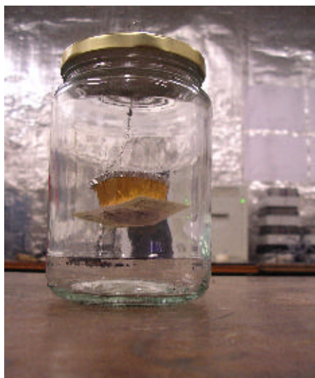
Figur 6. Alfasensorn klistrad under aluminiumkorgen
