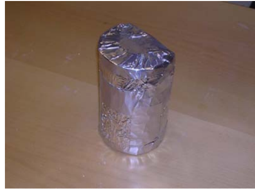
Figur 3.22: Prov förslutet med aluminiumfolie och aluminiumtejp
