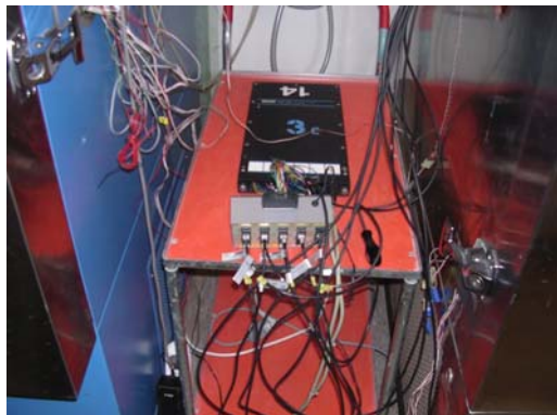
Figur 3.7: Mätstation lth: Picolog ADC 16
