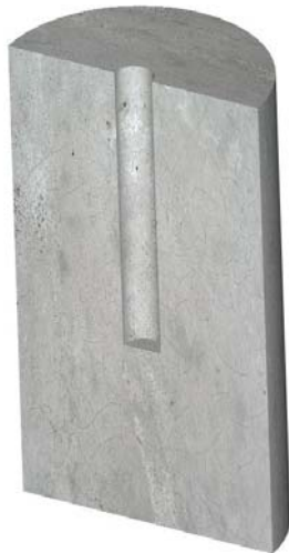
Figur 3.13: Tvärsnitt efter borrning
