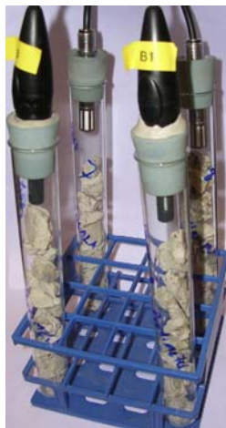
Figur 4.30: Mätning av RF i uttaget prov
