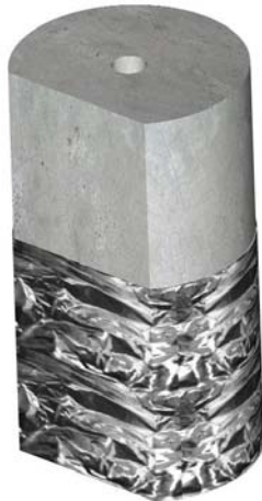
Figur 3.23: Sektionsritning av prov med tätning.
