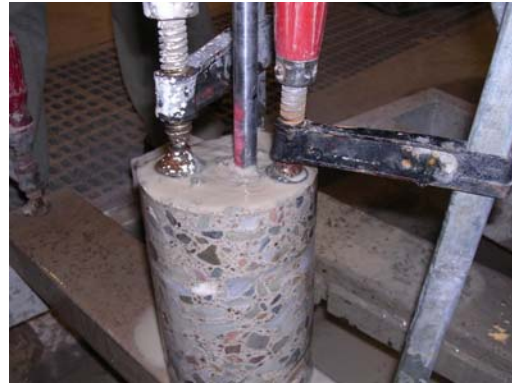
Figur 3.12: Håltagning i betongcylinder
