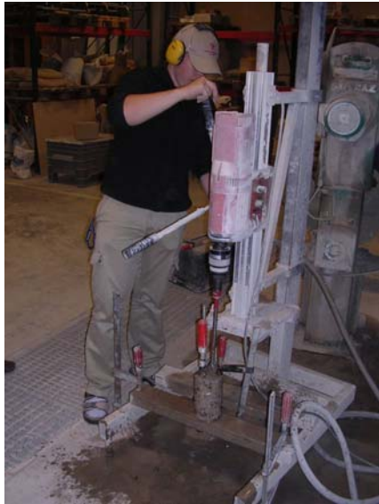
Figur 3.11: Håltagning i betongcylinder
