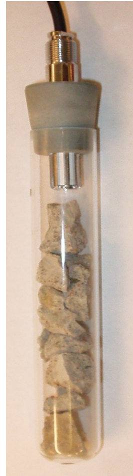
Figur 3.15: Provrör med monterad givare
