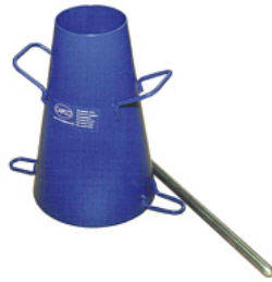
Figur 4.2 Sättkon och stålstav.
