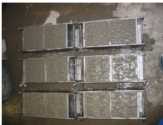
Figur 4.5 Kuber gjutna för hållfasthetsprovning.
