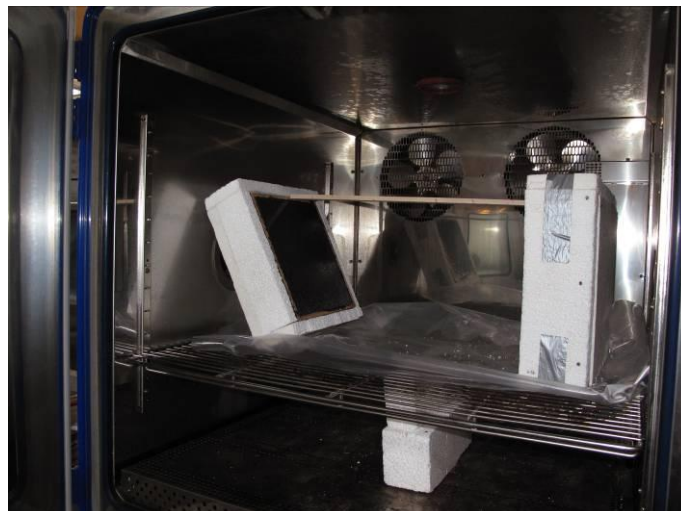
Bild 6.1 - Provkroppar placerade i klimatkammare
