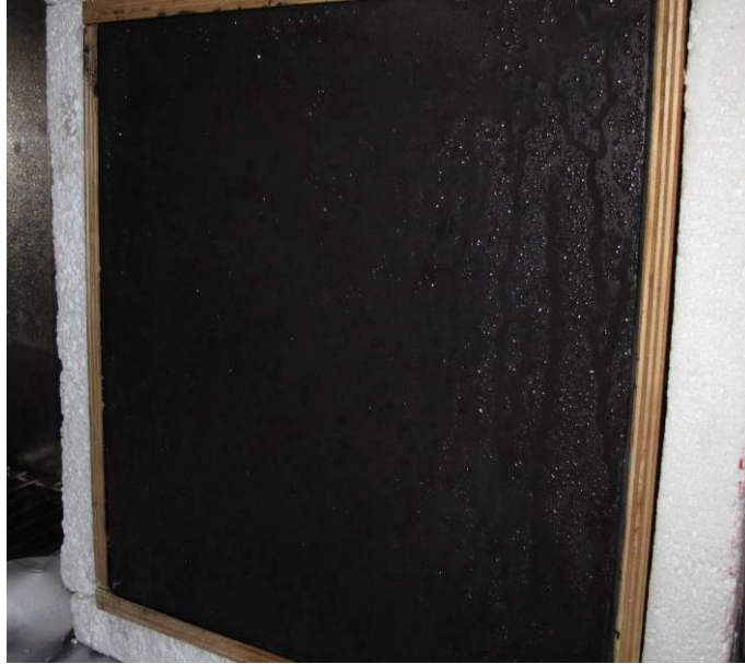
Bild 6.8 - Tydliga vattendroppar av kondens kunde ses på proverna under andra och tredje cykeln.
