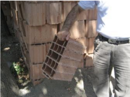
Fig. 113. Blocktegel, frigolit och betongblock är de nu dominerande materialen för golv och tak och används ibland även för väggar.
