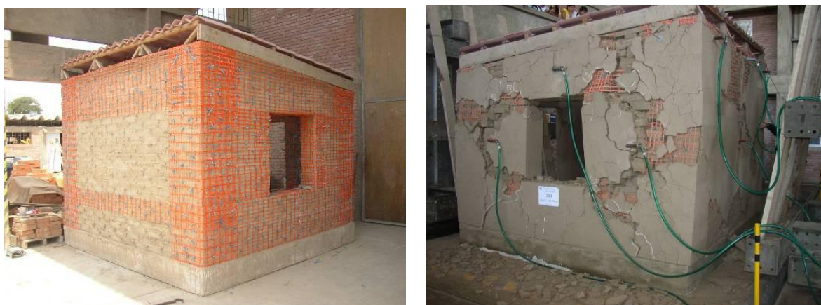
Fig. 148. Armering av plast och som täcker 75 procent av huset. Enligt tester så är det ett utmärkt alternativ till armering av småhus och dessutom ekonomiskt fördelaktigt för fattiga. (Marcial Blondet and Gladys Villa Garcia M (2007), Seismic Protection of Earthen Buildings ).
