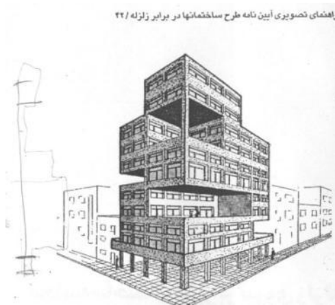
Fig. 14. En komplicerad struktur kräver komplicerade och kostnadskrävande jordbävningssystem. (IIEES)
