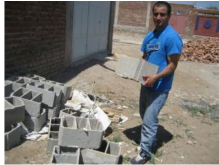
Fig. 113. Blocktegel, frigolit och betongblock är de nu dominerande materialen för golv och tak och används ibland även för väggar.
