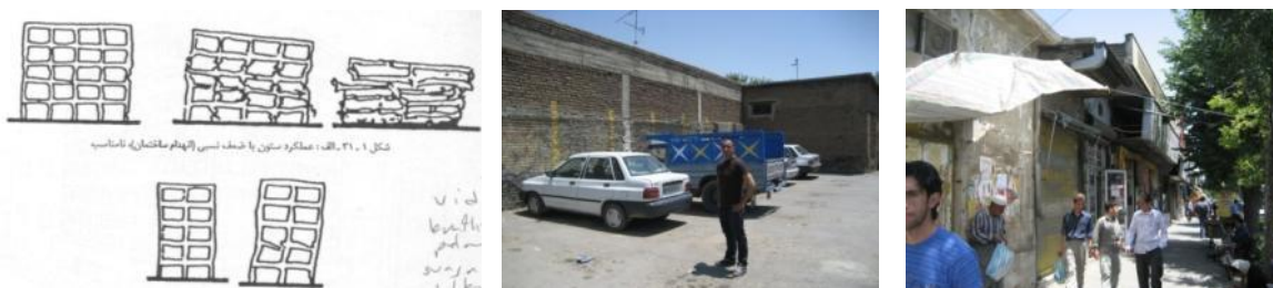
Fig. 27. Husets pelare ska prioriteras före balkar. En kollapsad pelare påverkar hela byggnaden medan en kollapsad balk endast har en lokal påverkan. Pelare ska vara tjockare än balkar.(IIEES)
