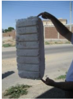
Fig. 113. Blocktegel, frigolit och betongblock är de nu dominerande materialen för golv och tak och används ibland även för väggar.
