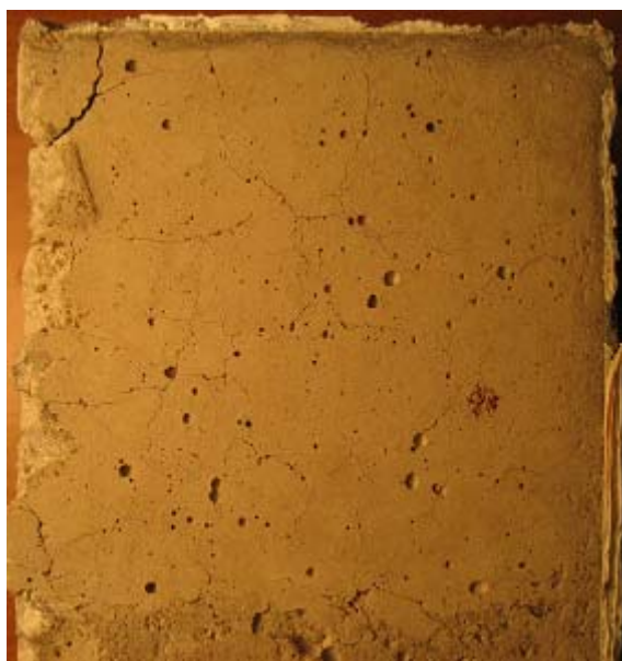
Figur 42 – Spräckmönster på betongen över vattenytan.
