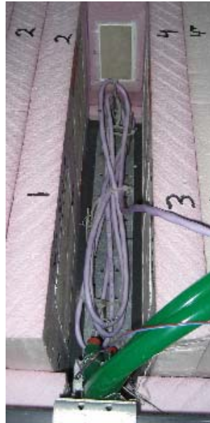
Figur 24 – Placering av värmeslinga och slangar från akvariepump.
