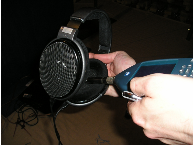
Figur 3. Bilden visar en mätning av ljudnivån i hörlurarna.
