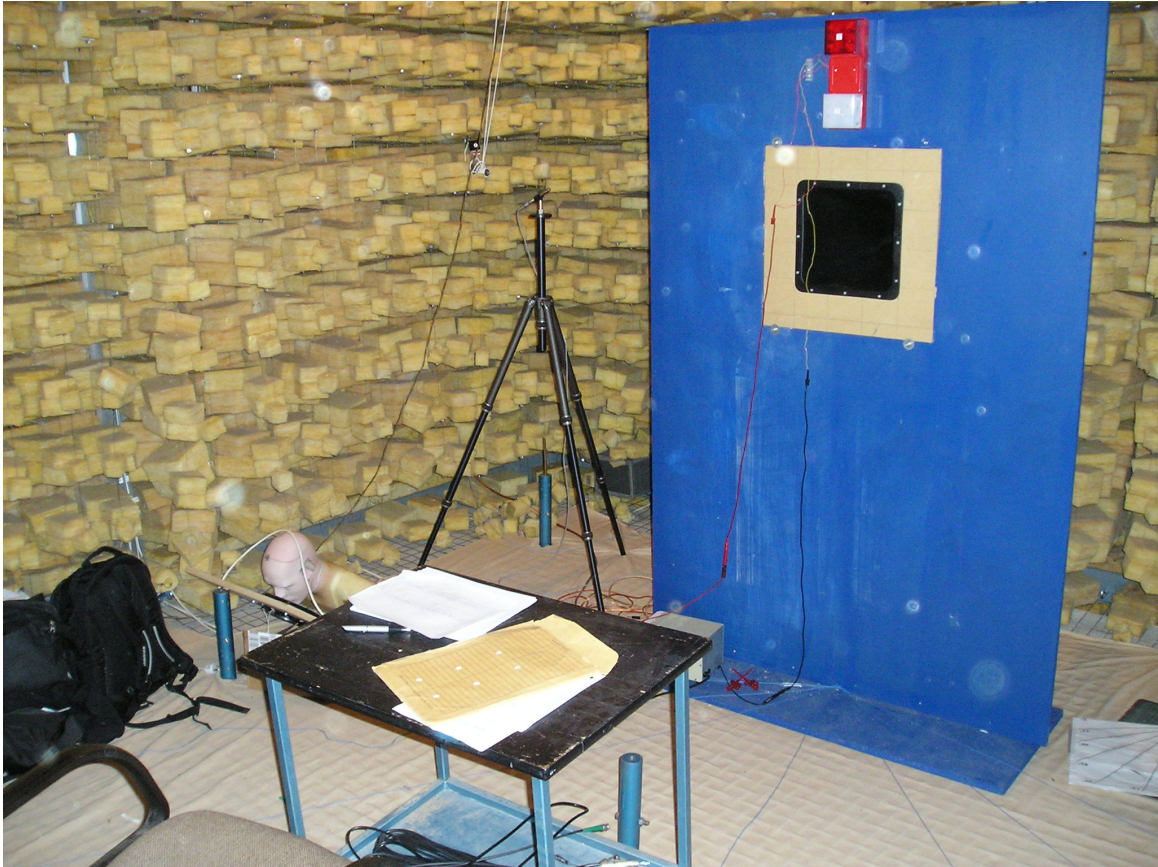
Figur 7. Bilden visar undersökningsuppställning i det ljuddöda rummet i V-huset. Det optiska larmdonet är fastsatt på väggen uppe till höger i bilden och nere till vänster sitter respondenten på en stol för att bedöma signalerna.
