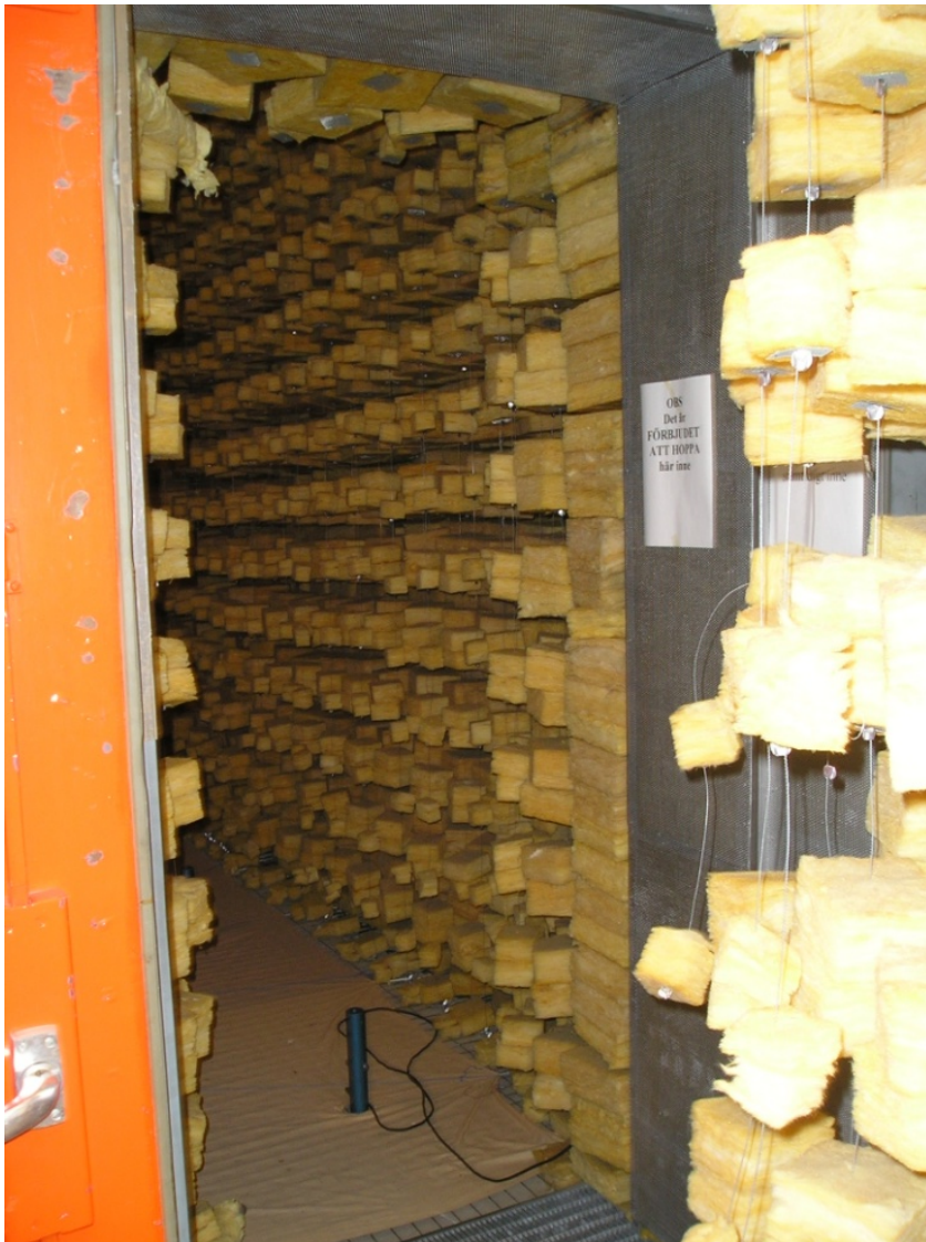
Figur 1. Bilden visar ingången till det ljuddöda rummet i V-huset Lunds tekniska högskola. Bilden visar även det ljudabsorberande materialet som är upphängt i rummet.
