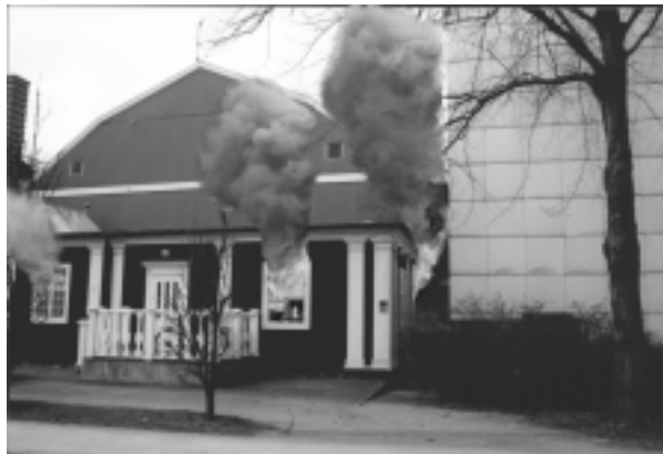
Figur 5.3: Flammor slår ut genom trasiga fönster i lägenheten
