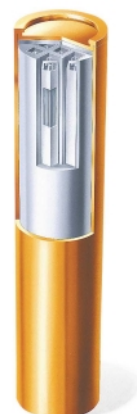
Fig. 2.2: Slutförvaringskapsel i genomskärning, man kan se: ytterhöljet av koppar, insatsen med bränslestavar i, innerlocket av stål och det påsvetsade ytterlocket av koppar.
