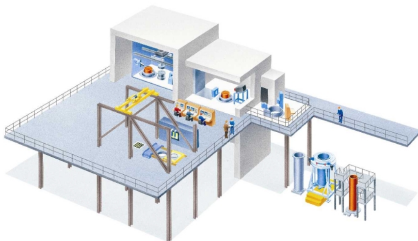
Fig. 2.3: De olika stationerna i Kapsellaboratoriet. Från höger till vänster, svetsstation, röntgenstation, ultraljudsstation, uppriktningsstation och i förgrunden hanteringsstation.
