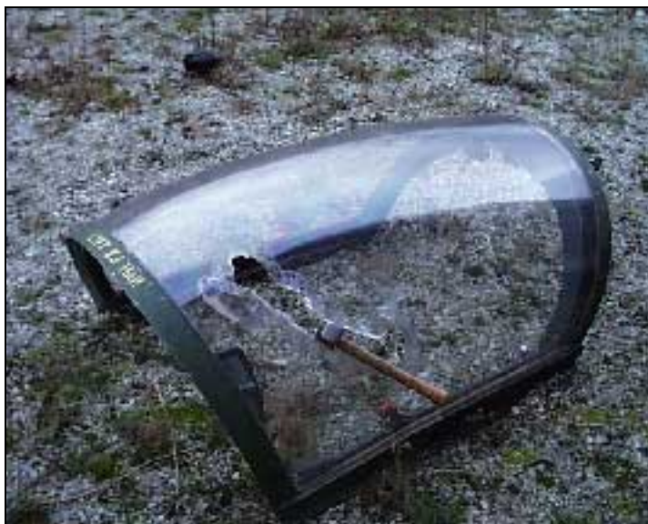
Bild 6.4: Huv utsatt för mekanisk överkan.
