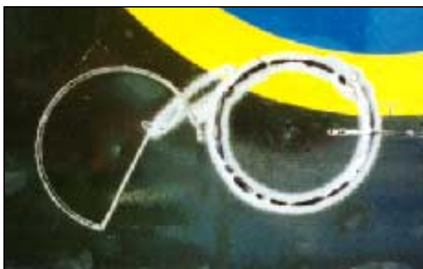
Bild 6.2: Aluminiumplåt skuren med skärsläckaren.
