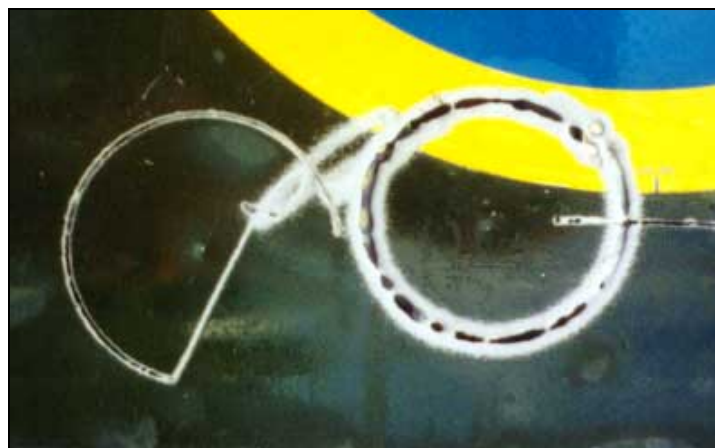
Bild B8.1: Aluminiumplåt skuren med skärsläckaren. Till vänster skuret med munstycket på 2 mm avstånd och till höger på 100 mm avstånd.
