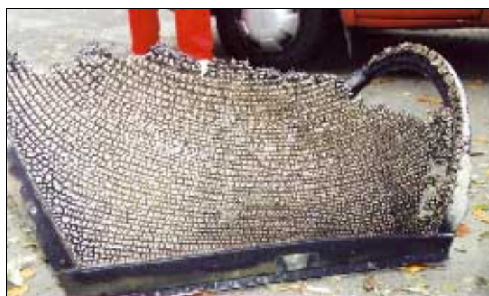
Bild 5.1: Huv efter fyra minuters brandpåverkan.
