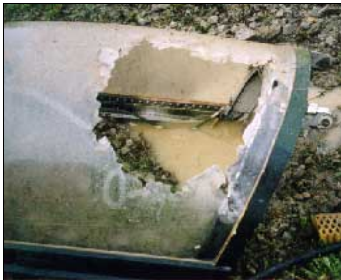
Bild 6.3: Splittrade kanter i huvmaterialet efter håltagning med skärsläckaren.
