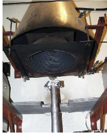
Bild 7-2 Konkalorimetern i Brandtekniks laboratorium (bilden är tagen av författarna, Lund, december 1999).
