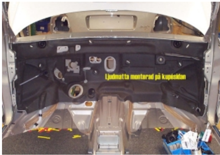
Bild 4-2 Ljudmattan monterad på kupésidan (bilden är tagen av Volvo Personvagnar AB).
