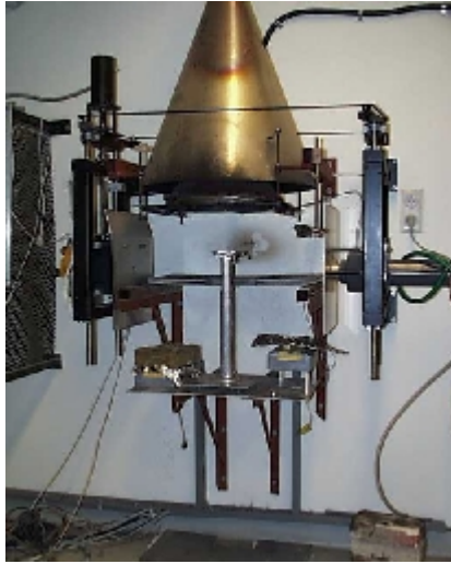
Bild 7-1 Konkalorimetern i Brandtekniks laboratorium (bilden är tagen av författarna, Lund, december 1999).
