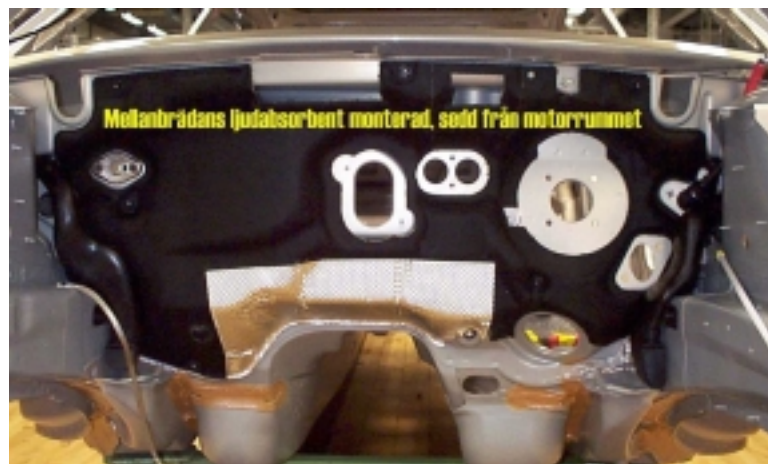
Bild 4-1 Ljudabsorbenten monterad på plåten (bilden är tagen av Volvo Personvagnar AB).
