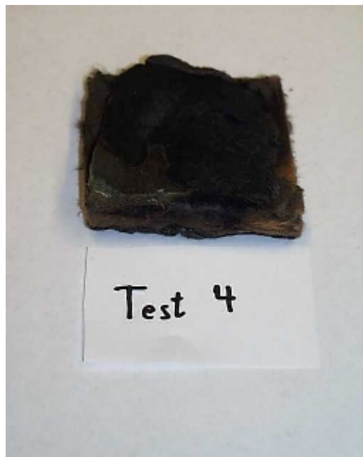
Bild A-4 Provkroppen efter utfört försök - konkalorimeter test 4. Observera att förkolningen av textillumpen fortsatt vid avsvälningen av provet (bilden är tagen av författarna, Lund, november 1999).
