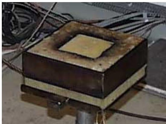
Figur B.2.2. Provkropp och mineralull i hållare.
