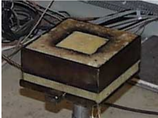
Figur 8.1. Provkropp med omslutande mineralull i hållare.
