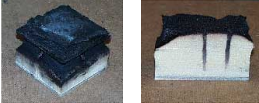
Figur 8.3-8.4. Provkropp hel och delad efter konkolorimetertest 3(50 \text{ kW/m}^2) .
