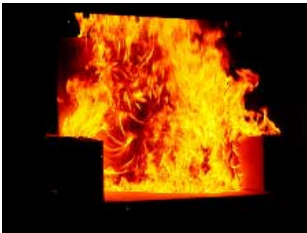
Bild 2.5 Fåtöljen 50 sekunder efter antändning.
