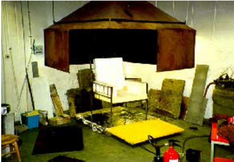
Bild 2.3 försöksuppställning vid konkalorimetertest. Vid testet hängdes alla skärmar på huven.
