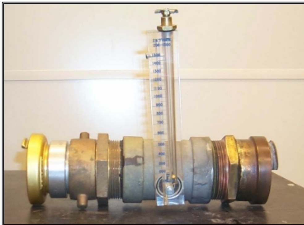
Bild 6. Vattenflödesmätare, mekanisk, typ II av märket ORO Fire Hydrant.
