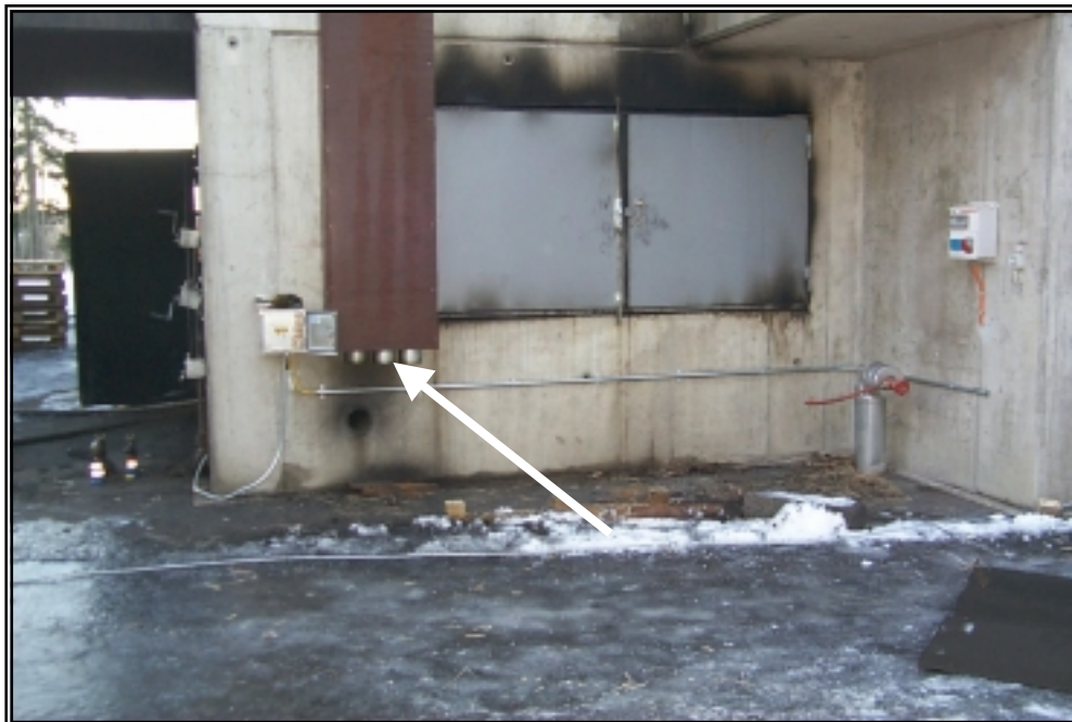
Bild 12. Kopplingsdosa för anslutning till termoelementtrådet, (ventilationshålet markerat med pil).
