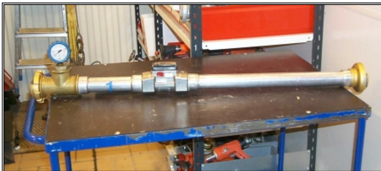
Bild 5. Vattenflödesmätare, mekanisk, typ I..
