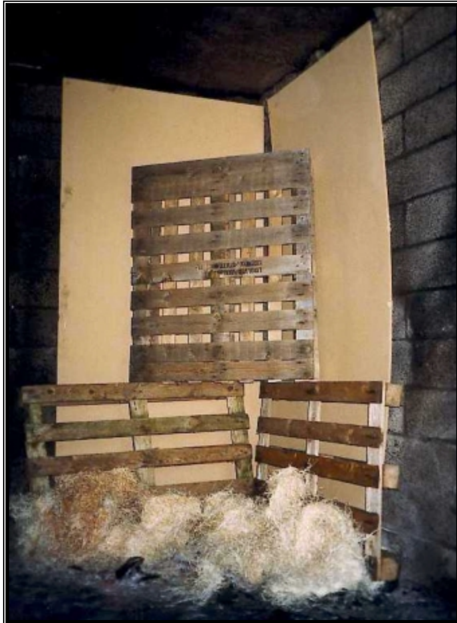
Bild 4. Uppställning av standardladdning som användes vid försöken.
