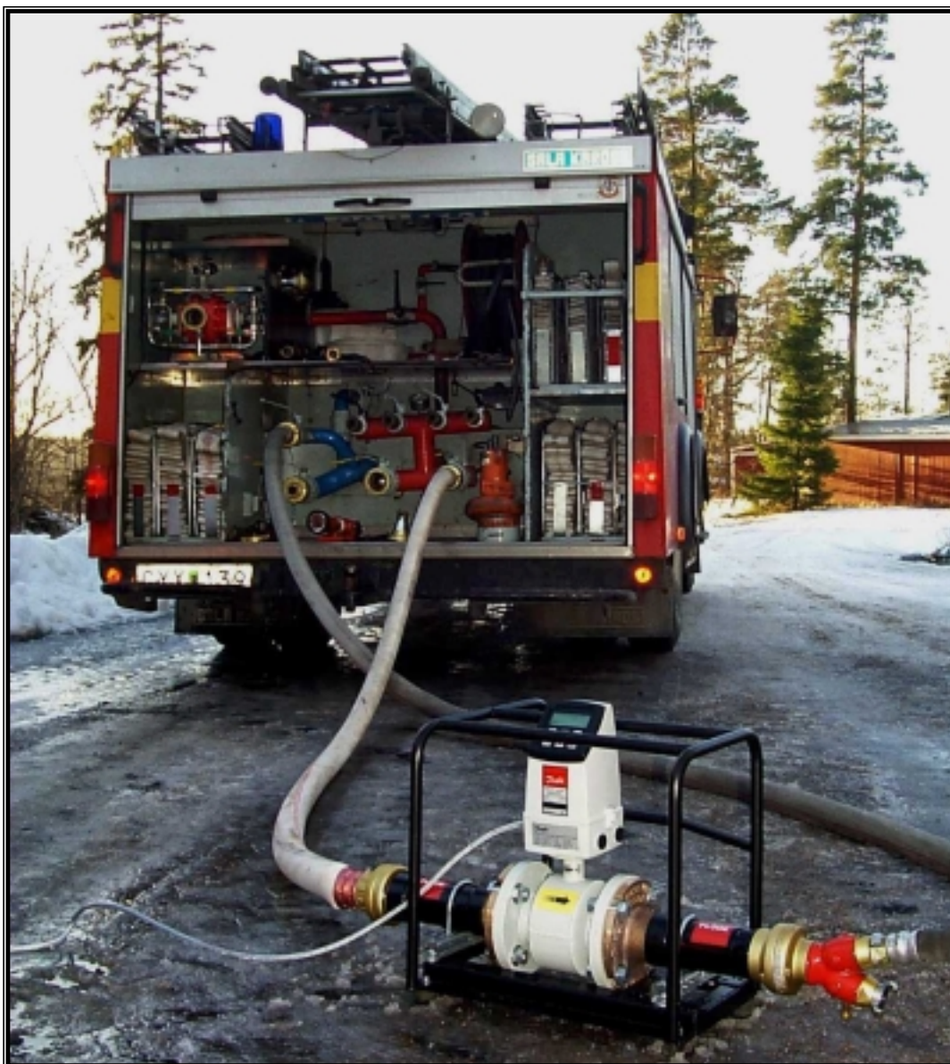
Bild 10. Den färdiga vattenflödesmätaren ansluten till mätrummet (sladd) och släckbil.
