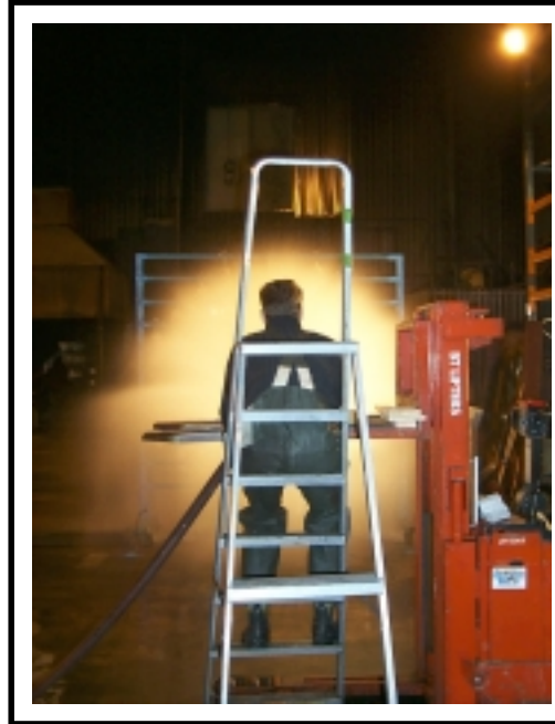
Bild 5.5: Försök vid SP, Borås, sett bakifrån. Notera att strålbilden precis täcker fångtavlan.
