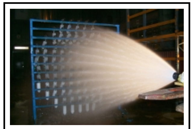
Bild 5.4: Strålbildstest vid SP, Borås. Strålrör med fast tandkrans.
