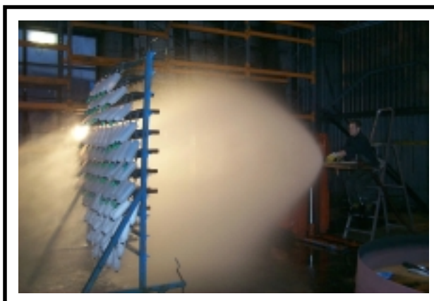
Bild 5.3: Strålbildstest vid SP, Borås. Strålrör med roterande tandkrans.
