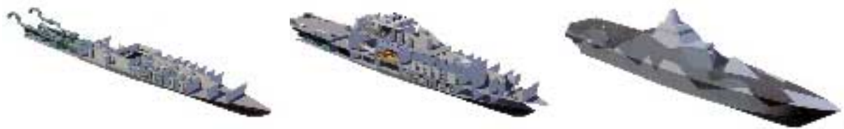
Bild 2.1 Konstruktionsuppbyggnad av HMS Visby /L/
